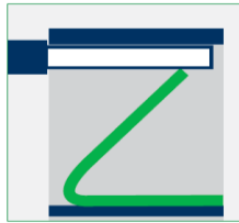
Druckfeder-Anschluss-System FRK Druckfeder-Prinzip
